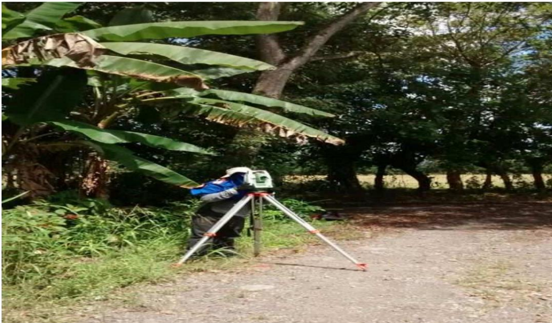
FIGURA 4.- LEVANTAMIENTO TOPOGRAFICO CON ESTACION TOTAL DEL CAMINO A SOL DAVID Y CALDERA SOLAR
